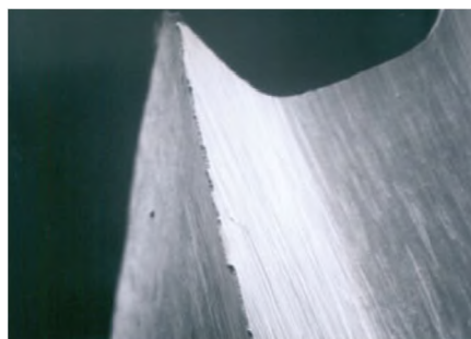
Зуб обычного бесстружечного метчика
