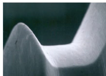
Оптимизированная поверхность бесстружечного метчика Profile фирмы Gühring
