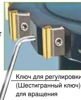
Ключ для регулировки (Шестигранный ключ) для вращения винта эксцентрика
